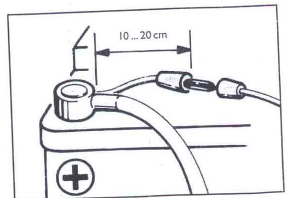
Kabellänge zwischen Batterie und Sicherung
