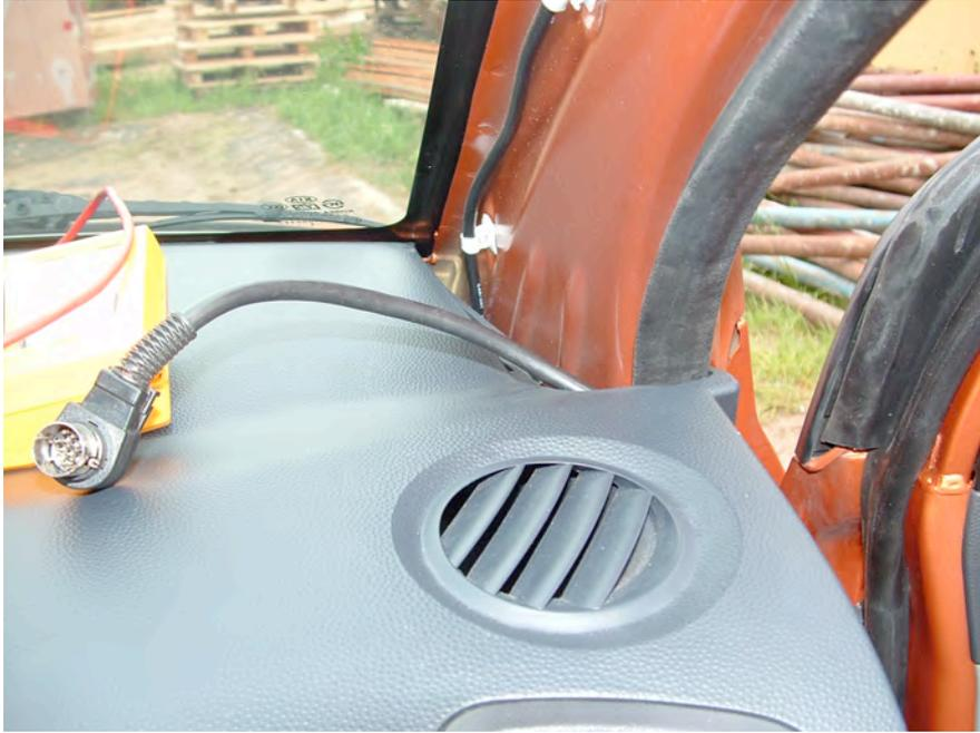
Das hier ist ein Fehlversuch. Ich hatte das Kabel seitlich neben dem Dichtgummi hinter das Armaturenbrett gewürgt. Das ist vollkommen unnötig. Wie man hinter dem Antennenkabel sehen kann, ist dort Platz genug um den Stecker bequem durchzuziehen. Entweder von oben durchführen oder von unter dem Handschuhfach nach oben durchfädeln.
