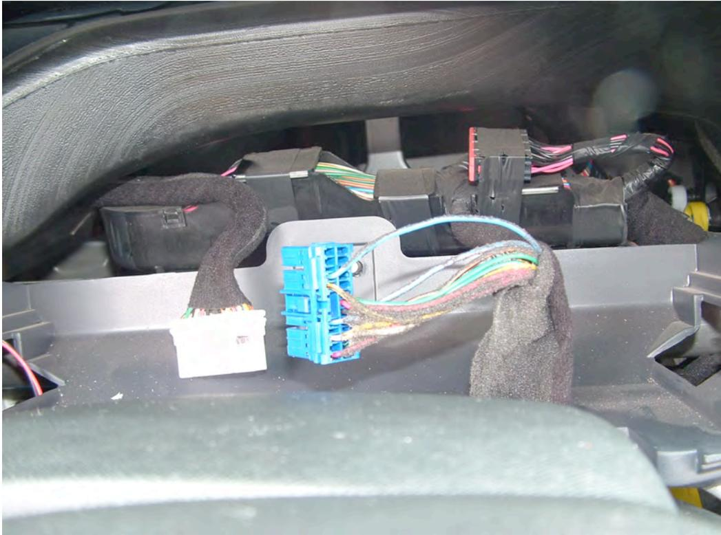
Mit einem Stromdieb nehmen wir dort das Tachosignal ab und befestigen es am schwarz-weißen Kabel des Navi-Kabelbaums. Ich hatte es einfach verlängert, deswegen das braune Kabel. Instrumente wieder einbauen und auf Funktion testen.
