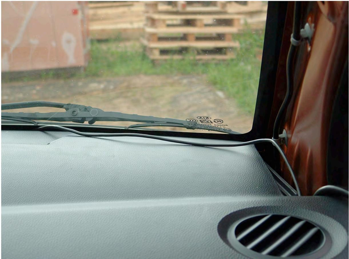
Das Kabel passt hervorragend zwischen Scheibe und Armaturenbrett. Mit einem kleinen Schraubenzieher kann man das Kabel vorsichtig unter die Abdeckung drücken. Das sieht man hier im Bild links.
