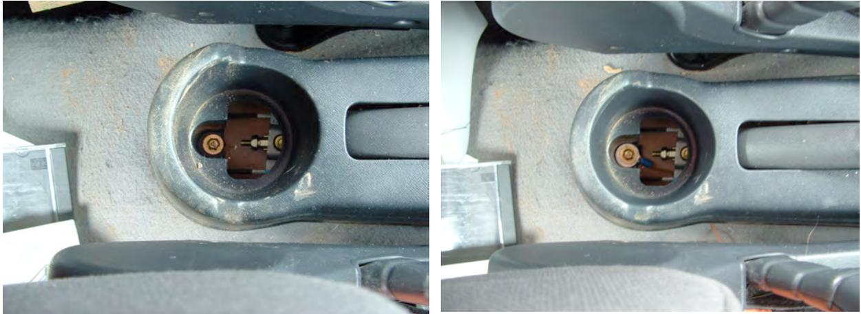
Das Massekabel an dem vorhandenen Kabelhalter befestigen, damit es nicht mit den Füßen herausgerissen werden kann.
