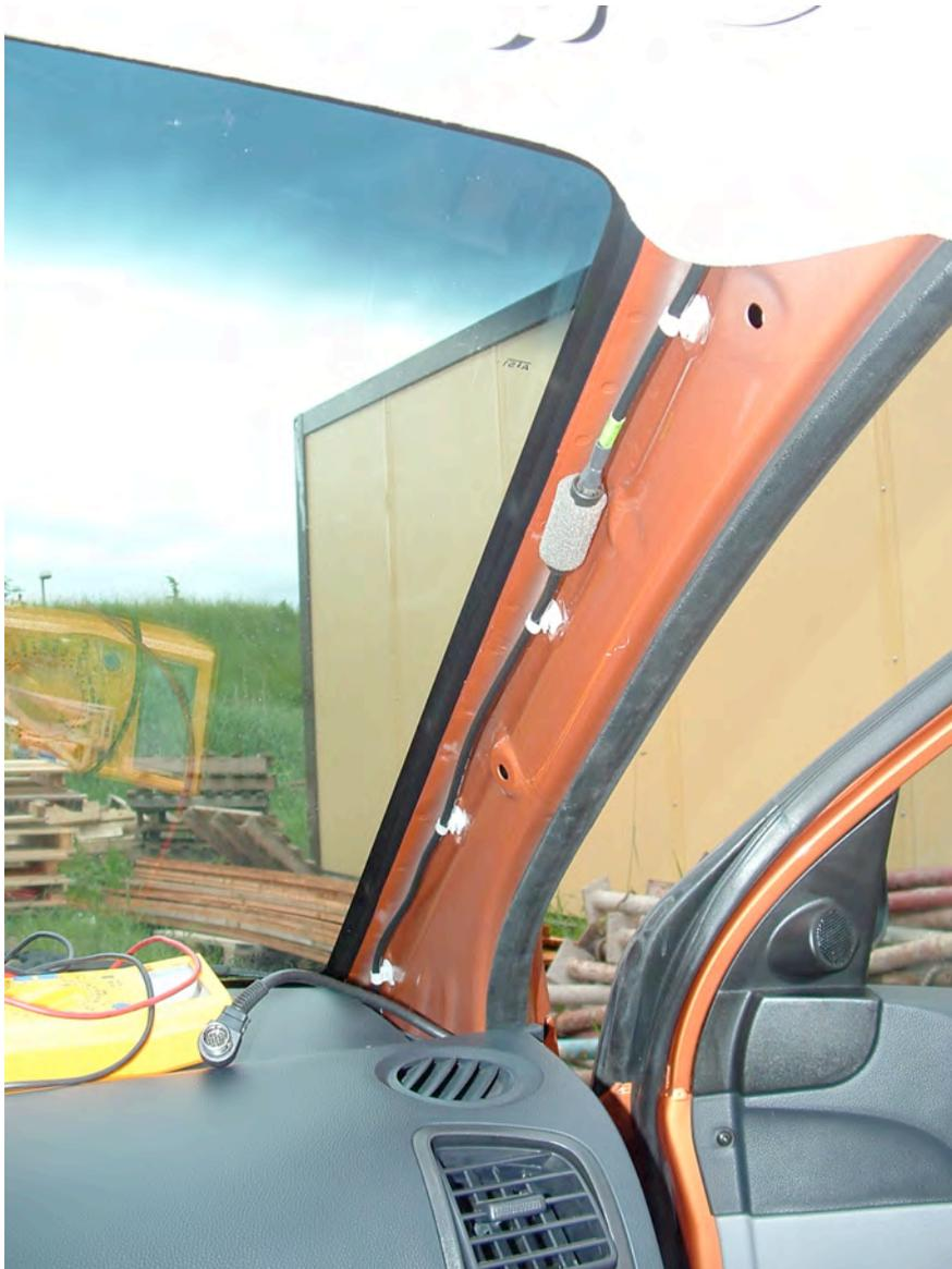
An der Säule sieht man das Antennenkabel, Der Knubbel ist ein Steckverbinder. Falls man gleich eine Scheibenantenne nachrüsten will: jetzt ist der Zeitpunkt dafür. Neben dem Multimeter sieht man schon das Kabel des Display, welches ich bereits verlegt hatte. Aber mehr dazu gleich.
