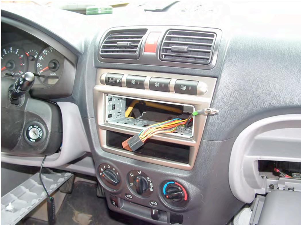
Nun lösen wir die Instrumente. Dazu lösen wir die beiden Schrauben oben unter der Blende und ziehen den vorderen Rahmen unten aus der geclipten Halterung nach vorne.
