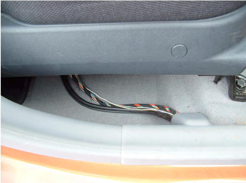
Nun können wir noch die Kabel mit einem Schlauch verkleiden. Ich habe einen Schlauch vom Hausbau dazu verwendet. Diesen habe ich einfach längs aufgeschnitten und mit schwarzen Isolierband wieder geschlossen, so dass das Kabel nicht wieder herausrutschen kann.
