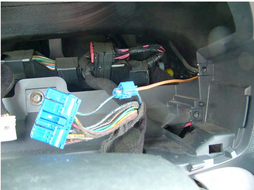
Ich wollte das Navigationssystem abschaltbar machen. Normalerweise schaltet es sich mit dem Motorstart ein, aber so oft brauche ich es ja nicht. Also brauchte ich einen Schalter. Dieser sollte nicht in einem Bauteil befestigt werden, das man nicht einfach für einen Rückbau wechseln kann. Daher wählte ich die untere Abdeckung der Lenksäule aus. Der Schalter sollte links seinen Platz finden.
