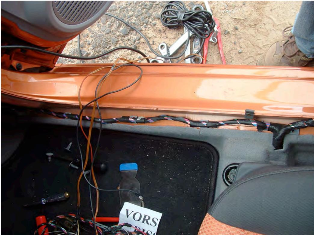
Das weiße Kabel mit den kurzen grauen Streifen ist das Kabel für den Rückwärtsscheinwerfer. Daran schließen wir das weiß-gelbe Kabel des Navi-Kabelbaums an.
