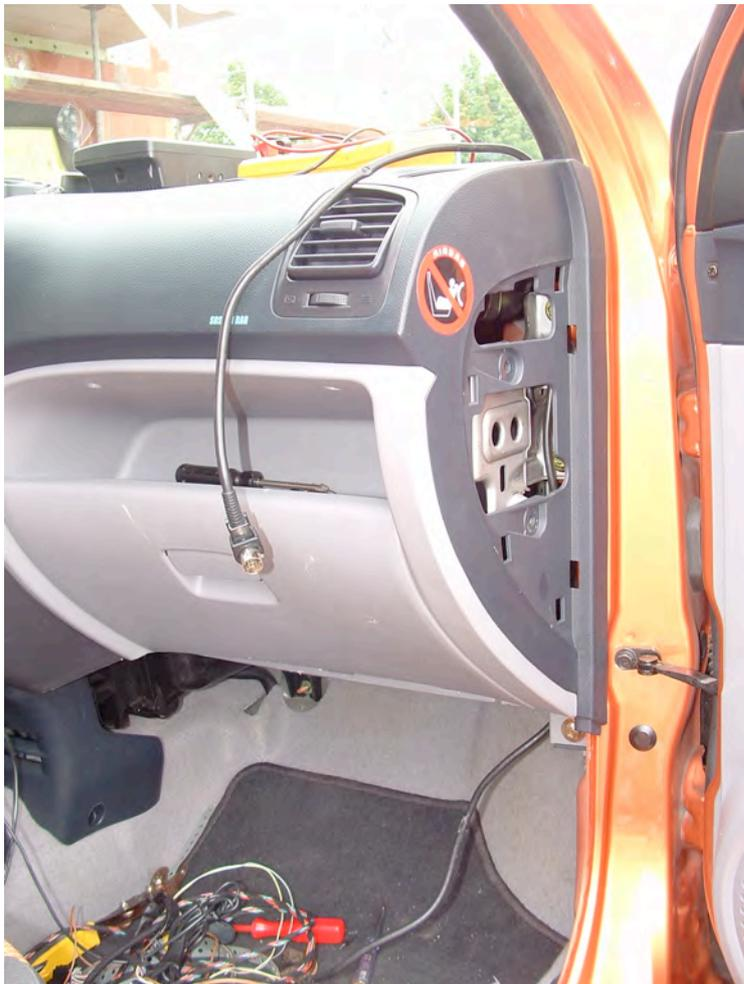
Jetzt noch das Kabel der GPS-Antenne ebenfalls diesen Weg gehen lassen.
