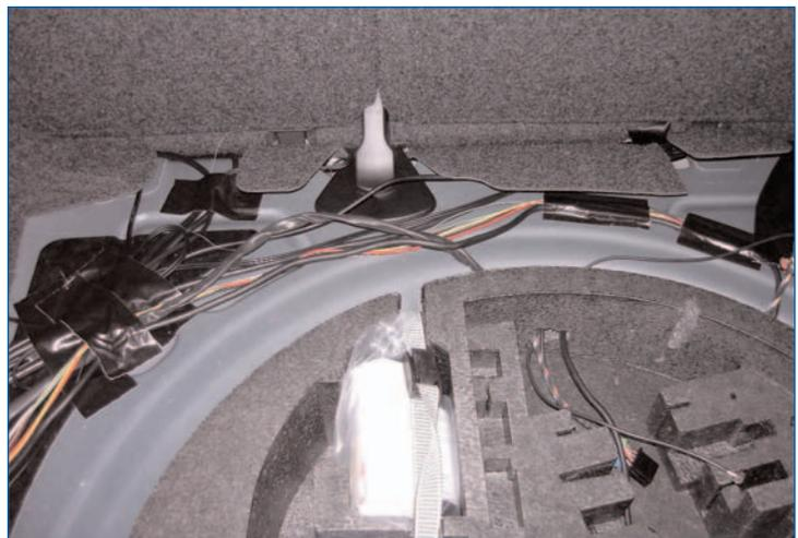
Der Schaumstoff Einsatz muss angepasst werden.
