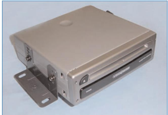
Den PC 5500/5400 in das Ablagefach im Kofferraum montieren, dazu muss die Schaumstoff Abdeckung auf der rechten Seite ausgefräst werden. Dann die Kabel bis zu dem Loch verlegen und durchführen (siehe Abb.).
