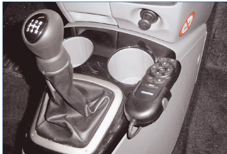
Anschlusskabel unter der Mittelkonsole zum rechten Fußraum führen.
