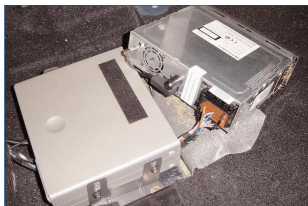
Découper la moquette aux dimensions requises et la rabatter vers le siège arrière. Découper la moquette sous l'emplacement de montage sur le côté du tirant vers le passe-câble. Avant de fixer le module, disposer le câble vers le module sous la moquette par le côté droit. Brancher le câble et le module et fixer ce dernier avec la patte.
