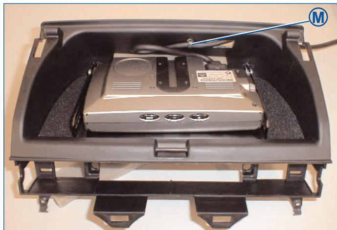
Engager le câble du moniteur avec le connecteur droit dans le trou prévu et le brancher au moniteur. Tirer une longueur de câble suffisante (environ 100 mm) et fixer la prise du câble et l'attache (**M**) dans les perçages (voir figure). Après insertion complète du moniteur sur le bloc de mousse, la longueur de câble doit s'engager dans une rainure. Après contrôle du montage et mise en place du câble, le collier doit être serré et la partie dépassante coupée.
