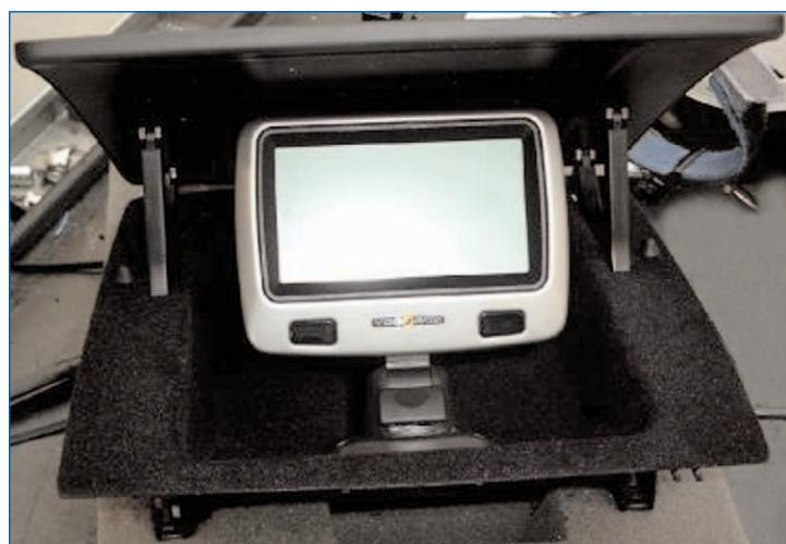
Ablagefach wieder einbauen und mit einer Schraube in der Mitte fixieren.
