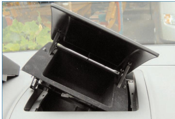
Das Aufbaugehäuse MKM5610Touran/40 aufsetzen und mit den drei beiliegenden Schrauben befestigen.
