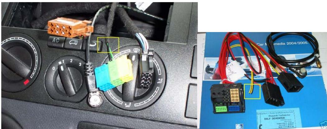
Als letztes wird das Mute-Kabel des Radio-Adapters in das Mute-Kabel im schwarzen DIN-Stecker eingelötet. Die genaue Position des Kabels kann man der Steckerbelegung entnehmen die auf dem ursprünglich verbauten Radio aufgeklebt ist.
