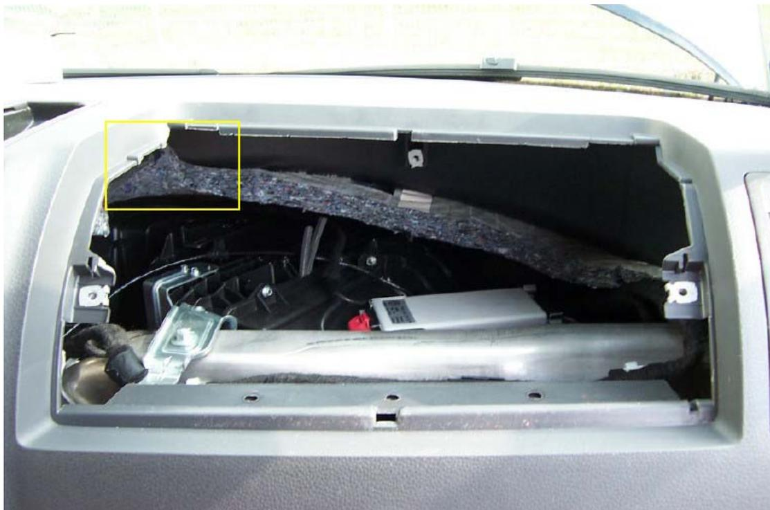
Die GPS-Antenne habe ich in dem gekennzeichneten Bereich auf die Dämmwolle gelegt, wobei durch die vorhandene Klebefolie der Dämmwolle gleich eine optimale Befestigung erfolgte. Das Kabel muss natürlich wieder zum Radioschacht verlegt werden.
