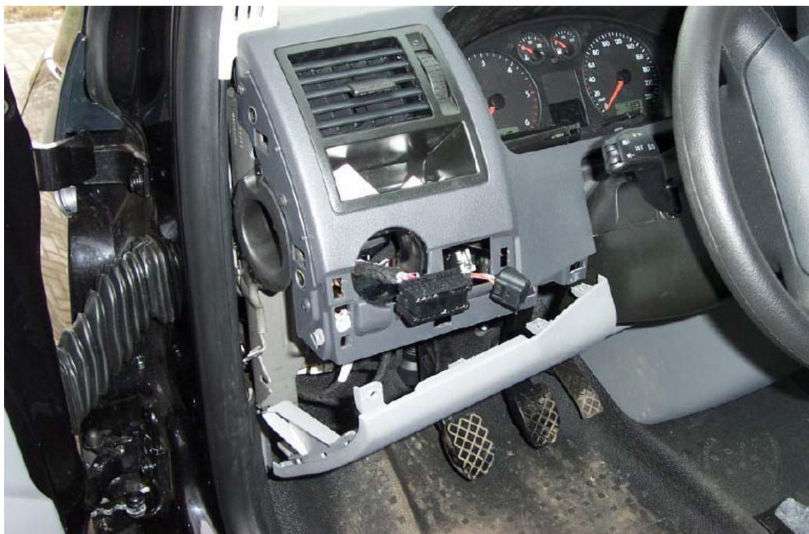
Die Verkleidung ist unter der Lenksäule mit dem rechten Verleindungsteil verbunden.
