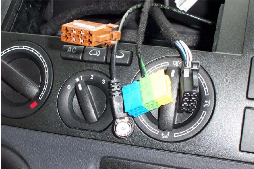
Jetzt muss man die mit CAN-high und CAN-low gekennzeichneten Kabel des Radio-Adapters über den Radioschacht hinterherum zum Cockpit ziehen.
