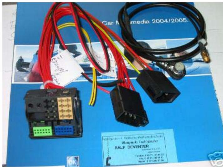
Dieser Adapter besteht aus den DIN-Steckern zur Aufnahme der originalen Radio-Stecker, zwei Leitungen zum Anschluss der CAN-Bus-Leitungen, zwei Leitungen zum Anschluss der eventuell vorhandenen Freisprecheinrichtung des Handy's und einer Leitung für die dann notwendige Telefon-Stummschaltung.
