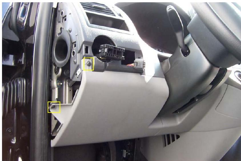
Die untere Verkleidung lässt sich dann durch das Entfernen der sichtbar werdenden Schrauben entfernen
