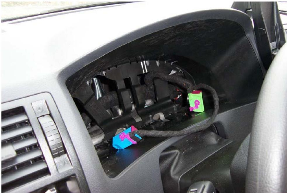
Für bessere Platzverhältnisse den Kabelbaum durch das Loch nach hinten stecken und durch die Öffnung weiter links wieder zurückholen.
