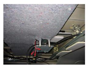
Um einen relativ großen und schweren Deckenmonitor sicher zu verankern ist eine stabile Unterkonstruktion notwendig. Dazu wurde der hintere Dachhimmel ausgebaut. Zwischen den Querstreben des Dachs wurden stabile Aluminium Längsstreben in Fahrzeuglängsrichtung geschraubt. Diese Längsstreben wurden mittels PU-Karosserieklebstoff mit der Dachhaut verklebt um die Stabilität und Festigkeit noch zu erhöhen.
