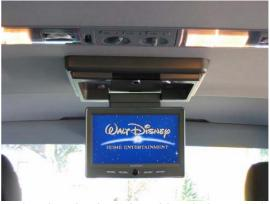
Fertig montiert wird der Blaupunkt 9,0" 16:9 Monitor mit seiner hochwertigen Verarbeitung und sehr guten Bildqualität zum Blickfang. Die Größe ist für den T5 ideal, der Monitor sitzt nicht zu nahe an den Frontsitzen um in Kopfhöhe zu stören, der Blick des Fahrers aus dem rechten mittleren Seitenfenster wird nicht beeinträchtigt und im eingeklappten Zustand ist der Innenspiegel voll nutzbar.
