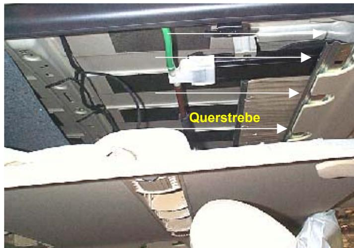
Nach kurzer Zeit machten wir eins: Wir brachten den Himmel an seinen ursprünglichen Platz und hatten zuvor die Maße aufgeschrieben, wie und wo wir den Alurahmen durchbohren müssten. So kam es, dass wir durch den Original-Himmel die Löcher zunächst mit einem 4 er Bohrer und danach mit einem 6 er durchbohrten. Dabei war die Längsseite des Alu-Rahmens mit 4 Löchern so durchbohrt, dass es genau den Querträger traf und somit von oben festgemacht werden konnte.
