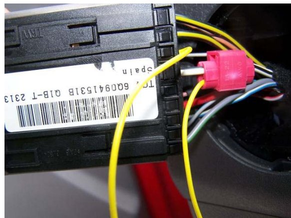
Anschluss über Stromdieb an KL56
