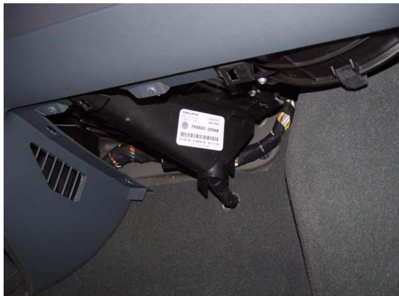
Navigationsrechner, TMC – Kabel, GPS Antenne und Monitorkabel ihren Platz gefunden hatten. Dazu haben wir die Muttern des Beifahrersitzes gelockert und die Kabel in die durch dieselbe Teppichöffnung geführt, die auch VW nutzt.
