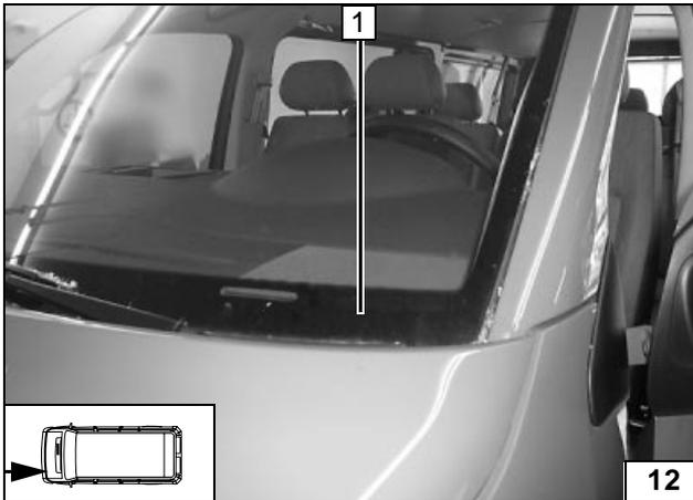
1 Antenne Funkfernbedienung
